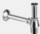
Pungvandlås - forkrømet messing Udstyr Kop Ø 50 mm, roset Ø32xØ80xH24 mm Kvalitetskontrol iht. DIN EN 274 model 5753.905
