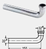
Afløbsbøjning 90° - forkromet messing model 5622.2
